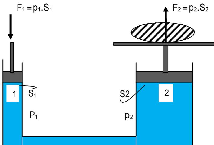
**Figure.2.3 :** Principe d'une presse hydraulique
