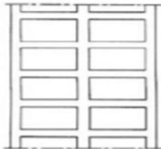
Figure 2 : Ossature en portique (à des travées)
